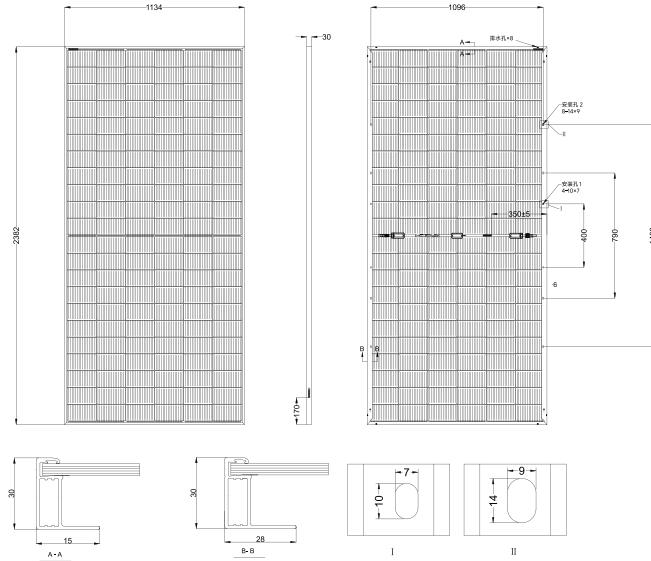
\* 长:±2mm 宽:±2mm 厚度t:±1mm 孔距:±2mm
